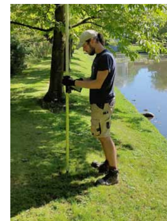
plaatsbepaling van de boring.
